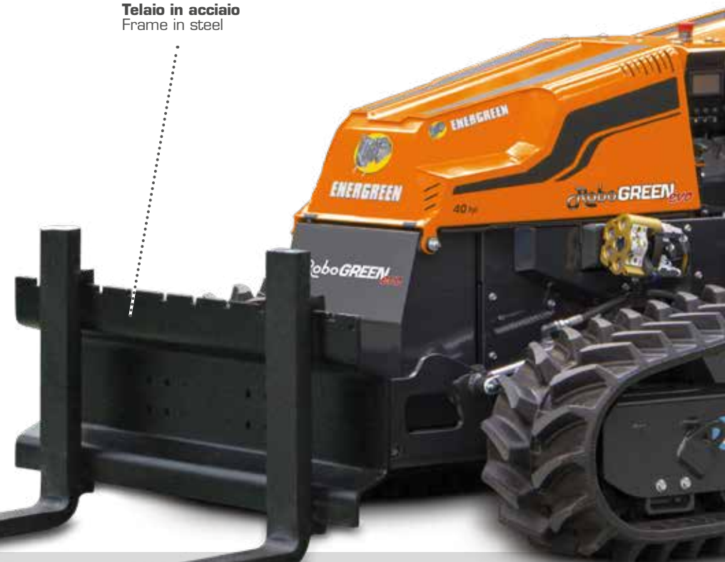
Forche robuste in acciaio lunghe 80 cm Robust steel forks 80 cm long
